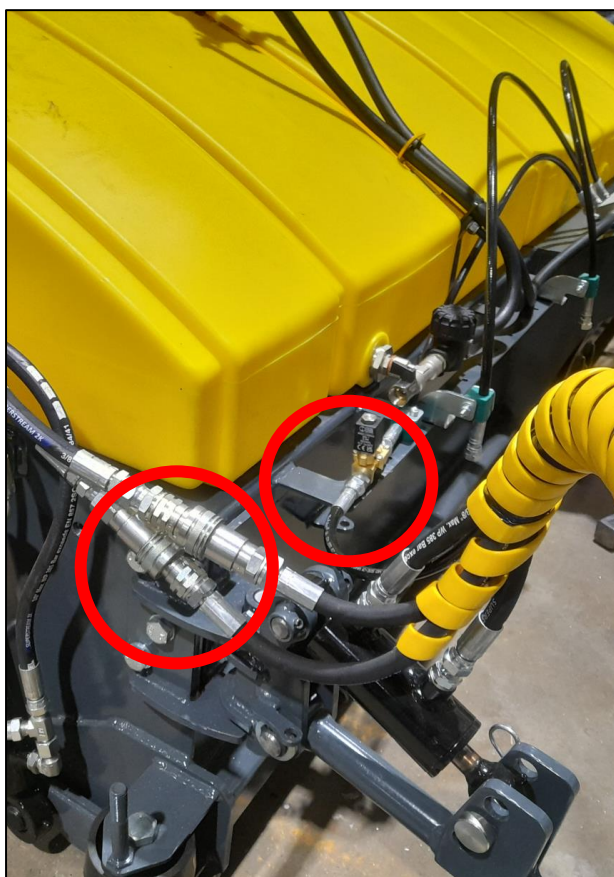
Figur 11. Sidoborstens hydraul- och bevattningsslangar monterade
