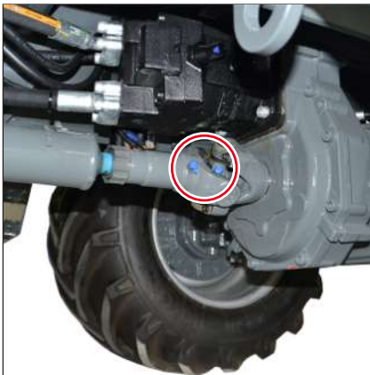
Kuva 343: Kardaaniakselin voitelukohta takapä
