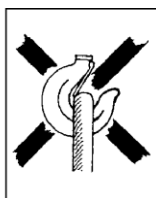
Fig. 2 c Kroksperran blokkert!
