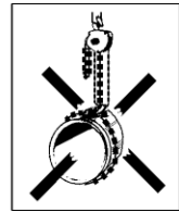
Kuva 2 e Kuormaketjua ei saa käyttää silmukkana!
