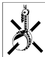
Fig. 2 e Lastekjettingen må ikke brukes som slynge!
