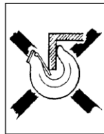
Fig 2 d Krokspetsen dessutom utsatt för böjpåkänning!
