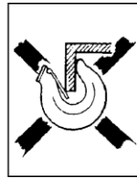
Kuva 2 d Koukun kärkeen vaikuttaa lisäksi vääntävä kosketusrasitus!
