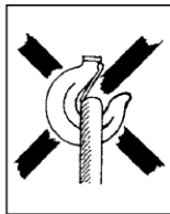
Fig 2 c Krokspärren blockerad!
