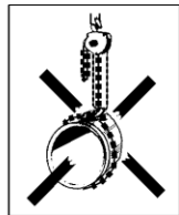
Fig 2 e Lastkättingen får ej användas som sling!
