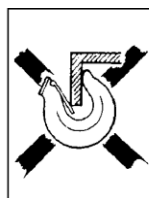
Fig. 2 d Krokspissen i tillegg utsatt for bøyingspåkjenning!
