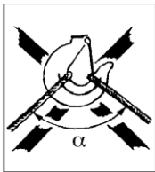
Fig 2 b För stor toppvinkel på slinget! \alpha max 60°
