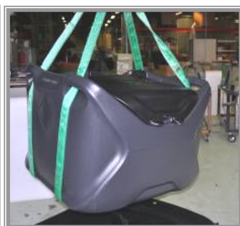
Kuva 3. Säiliön nosto täytenä
