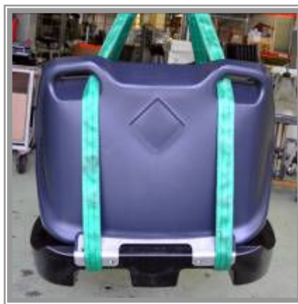
Kuva 5. Valuma-altaallisen säiliön nosto täytenä
