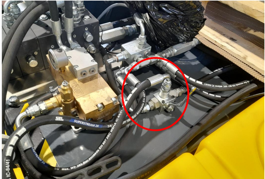
Kuva 31. Korkeapainepumppu ja 3-tie hana
