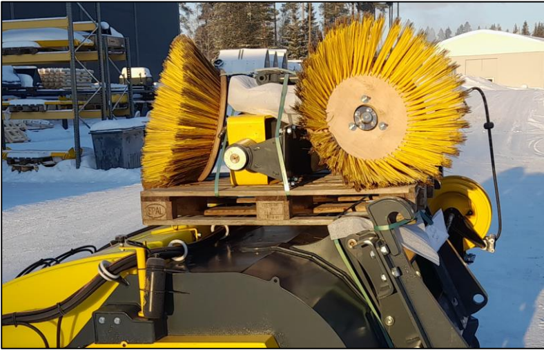
Kuva 4. Keräävä harjalaite pakattuna
