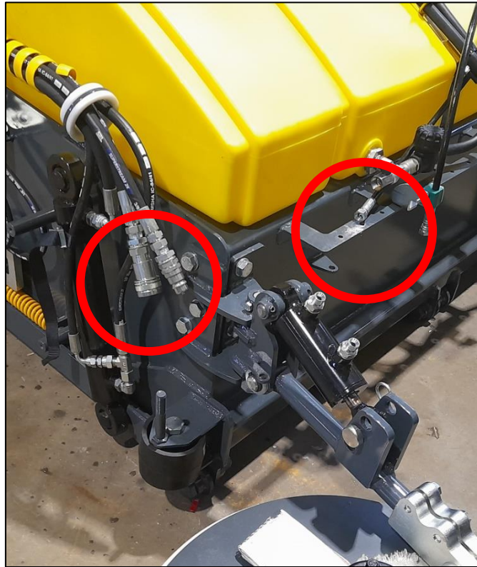
Kuva 10. Sivuharjan hydraulikka- sekä kasteluletkut
