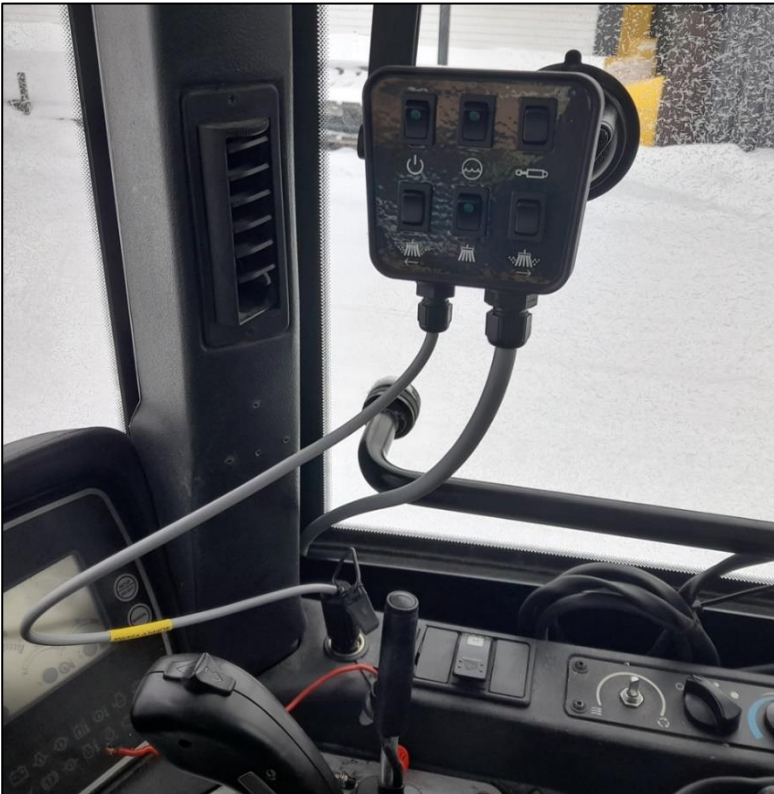
Kuva 16. Ohjaimen kiinnitys työkoneessa.
