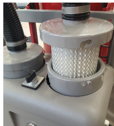
Figur 8. Vrid och lyft försiktigt toppen av filterhuset HEPA filter Scan Dust 2900.
