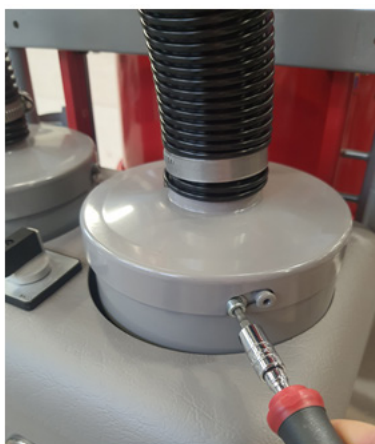
Figur 7. Toppen på HEPA filterhuset, Scan Dust 2900 (2) Avlägsna de två M5-bultarna som håller fast locket.
