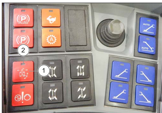
Figur 133: Återställningsknapp för rörelsesäkerhetssystem
