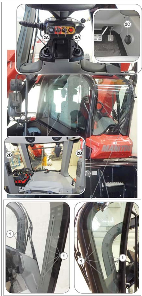
Figur 62: Avimningsdiffuserare och uppvärmningsventiler
