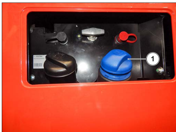
Figur 122: Fyllning av "DEF"-tanken
