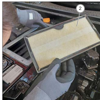
Figur 209: Byte av vevhusfilter för motoravluftningsventil
