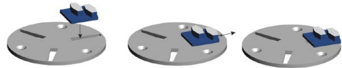
Figur 4-3 Hur man fäster slipsegmenten på Scan-On-fästskivan
