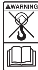
24 VAROITUS! Älä käytä hitsattua levyä kauhanvarrella nostoon. Lue käyttöohje (tarra koskee vain jos, koneessa on kuormanpidin)
