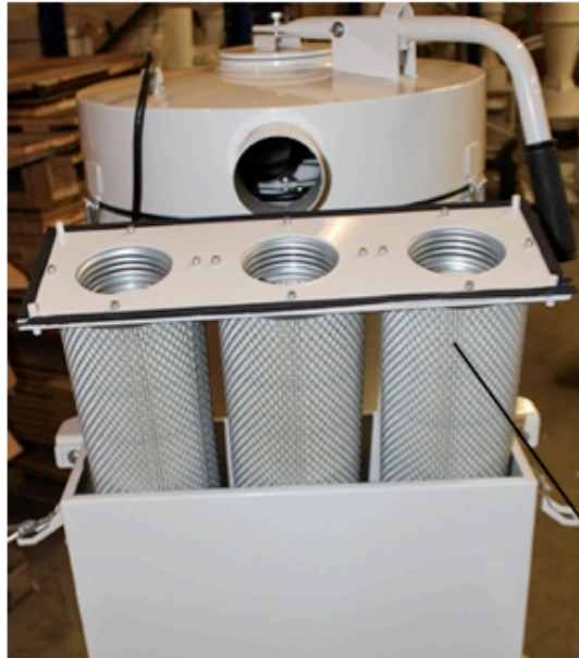
HEPA-suodattimet kiinnitetty kierrekiinnityksellä. Avaa kiertämällä suodatinta vastapäivään.
