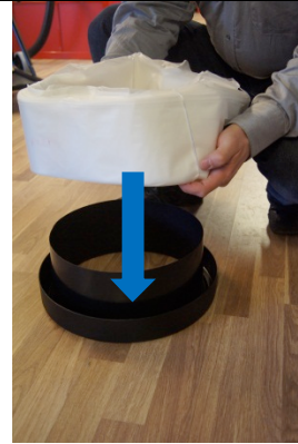
2: Laske Longopac sukka telineeseen huolellisesti kiinnitysnaurut paikalleen.
