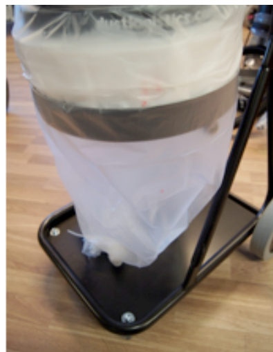
7. Longopac paikalleen asennettuna. Kuvan mukaisesti Longopacin vapaa yläreuna voidaan kääntää siististi aiemmin asennetun kiristyremmin päälle.
