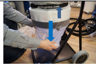
5: Aseta Longopac teline takaisin paikalleen. Vedä Longopacin vapaa reuna telineen ulkokehän sisästä, ja vedä kehän ulkoreunan yli ja alas. Vedä samalla Longopacin sisäpuolinen vapaa muovireuna ylös imurin runkoa vasten ja kiristä kiristysremmi paikalleen.
