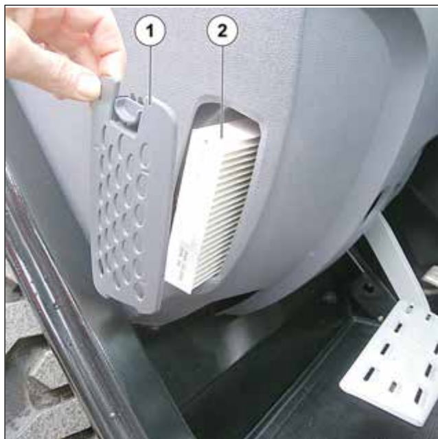
Figur 95: Byte av hyttventilationsfilter
