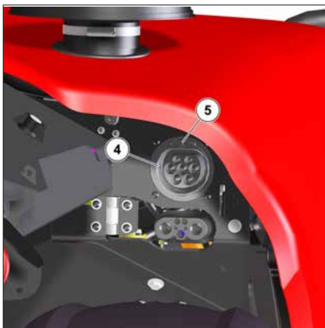
Figur 78: Laddar 100 V-batterierna och 12 V-batteriet
