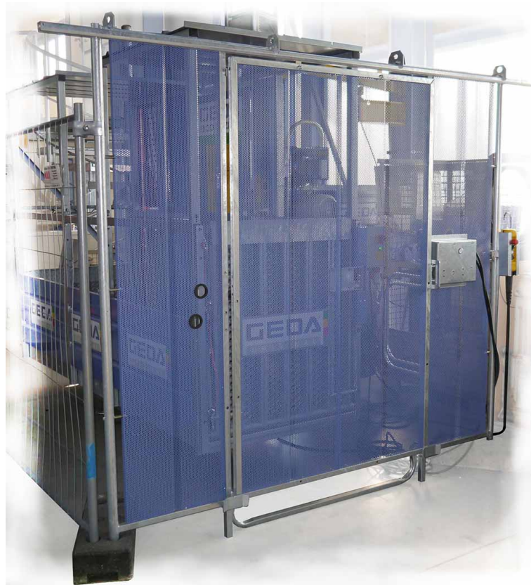
Kuva 18: Liukuovi maatazon suoja-aitaan suljettuna
