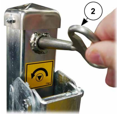
Kuva 36: Sähkömagneettisella säpillä varustetun puomin lukituksen hätäavaus
