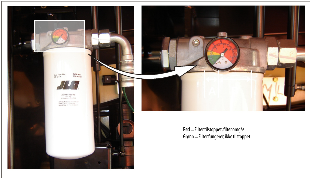
Figur 7-9. Tilstandsindikator for hydraulisk returfilter – Serienummer fra og med 139396 til nåværende
