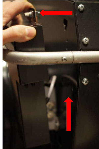
2. Vedä kotelon yläosa varovasti irti. Yläosan avauduttua nosta varovasti.
