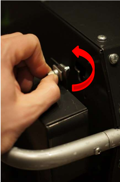
1. Kierrä anturikotelon lukitusruuvia vastapäivään. Tarvittaessa käytä ruuvimeisseliä.
