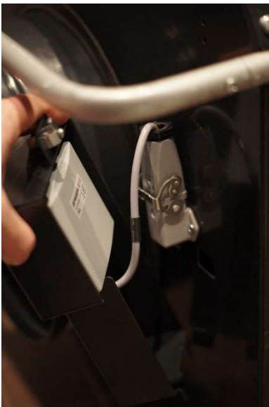
3. Nostettuasi kotelon paikaltaan anturin sähköliitin tulee näkyviin.
