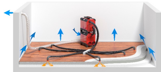
Trycktorkning. Turbinen matas med torrluft från avfuktaren och trycker ned denna i den skiktade konstruktionen.
