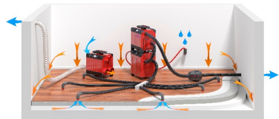
Sugtorkning. Avfuktaren torkar luften i utrymmet och turbiner drar upp luft ur den skiktade konstruktionen med följden att torr luft dras ned i den.
