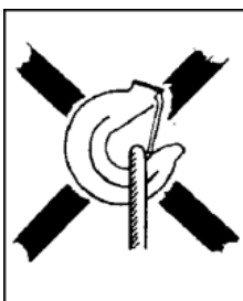
Kuva 2 a Silmukka kuormittaa koukun kärkeä!
