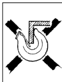
Kuva 2 d Koukun kärkeen vaikuttaa lisäksi vääntävä kosketusrasitus!
