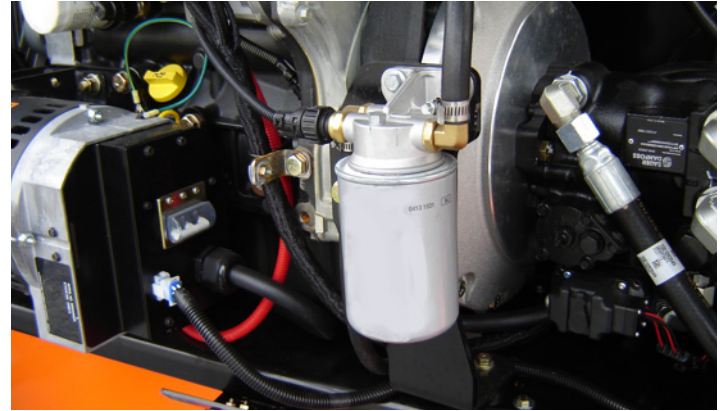
C. Polttoainesuodatin – Deutz TD2.9 (moottorissa)
