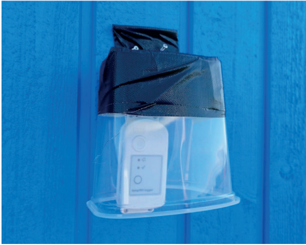
Ulkolämpötilan ja kosteuden mittaus
