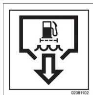
Polttoainesuodattimen vedenkerääjän tyhjennys
