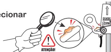
**Desgaste máximo da alavanca permitido 1,5 milímetros**
