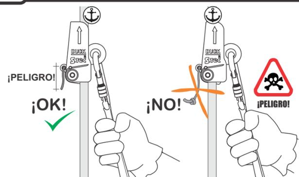
El cordino de posicionamiento está equipado de fábrica. Si se ha instalado un nuevo cordino no debe ser mayor de 40 mm y no debe tener ningún nudo en su extremo inferior.
