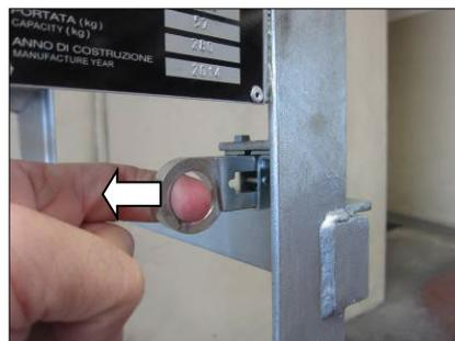
Après l'ouverture du dépôt, procédez au chargement manuel des bouteilles, deux de chaque côté, en faisant tourner la base jusqu'à ce qu'elle soit complètement posée sur le plan du dépôt.
