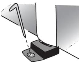
**6.** Manipulez toujours le barrage en le tenant par le bas des parois et n'utilisez pas les supports comme poignées. Ajustez la position en déplaçant le barrage par les bords. L'utilisation d'air sous le système de rétention permet de réduire les frottements et de limiter les abrasions.
