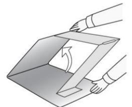
**4b.** Installation du modèle QuickBerm avec supports intérieurs – Dépliez et levez les quatre côtés. Verrouillez le support intérieur en poussant la partie articulée du support jusqu'au sol.
