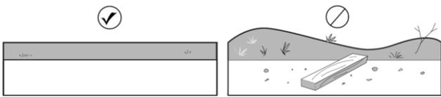
**1.** Choisissez un site offrant une surface plane et stable. Vérifiez bien que la zone de déploiement ne comporte pas d'objets pointus, de pierres, de ferraille, de branches, de débris de construction, etc.
