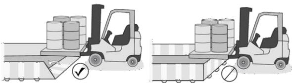
**7.** Avant d'entrer dans la zone ou d'en sortir, veillez à abaisser les parois dans la bonne direction afin d'éviter d'endommager le barrage.
