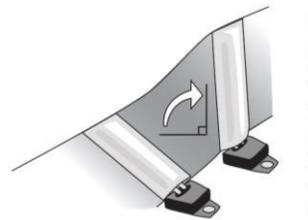
**4a.** Installation du modèle Rigid-Lock QuickBerm : Dépliez et levez les parois, puis fixez-les en verrouillant les supports dans les crans prévus à cet effet.
