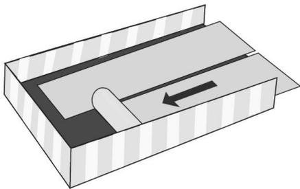
**5.** Si vous utilisez des rouleaux comme barrière de protection entre les bandes de roulement des pneus et le sol du barrage, vous devez dérouler le revêtement de protection dans le sens de la trajectoire suggérée pour les pneus des véhicules ainsi que dans le sens du sol du barrage.
