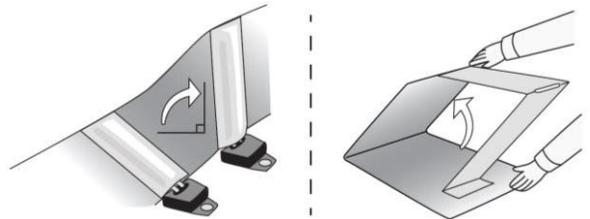
**4a.** Rigid-Lock QuickBerm Modell Aufbau: Falten Sie die Wände auf und stellen Sie sie auf, indem Sie die Stützen in die Arretierung der Stütze einrasten lassen.
