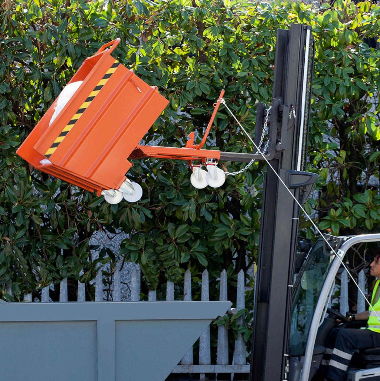
Contenitori ribaltabili con ruote e portata fino a 2000 Kg per raccolta, movimentazione e scarico di sfridi e altri materiali industriali. Il meccanismo di scarico si aziona senza scendere dal carrello elevatore per la massima efficienza e sicurezza.
