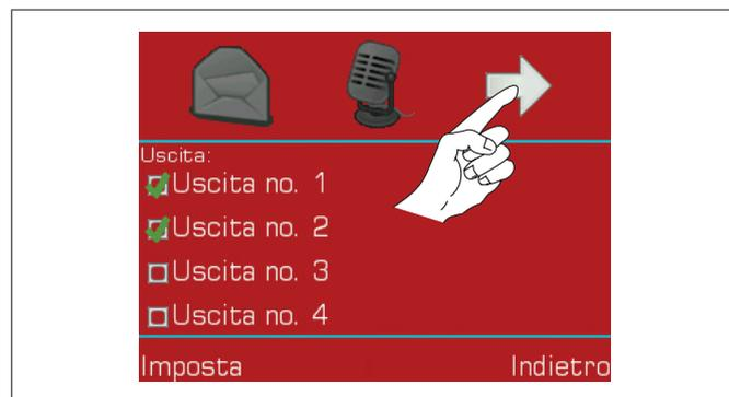
La **sequenza di allarme** di ogni trigger segue l’ordine di inserimento delle azioni. Nel caso di più azioni chiamate, il **CEGSM** tenterà di chiamare tutti i contatti associati. In caso di chiamata fallita o non risposta, proverà, dopo aver terminato le altre chiamate, per altre 5 volte di default (modificabile in “Impostare la sequenza di chiamata allarme” a pag. JUSTRITE®) a richiamare i numeri che non hanno risposto.
