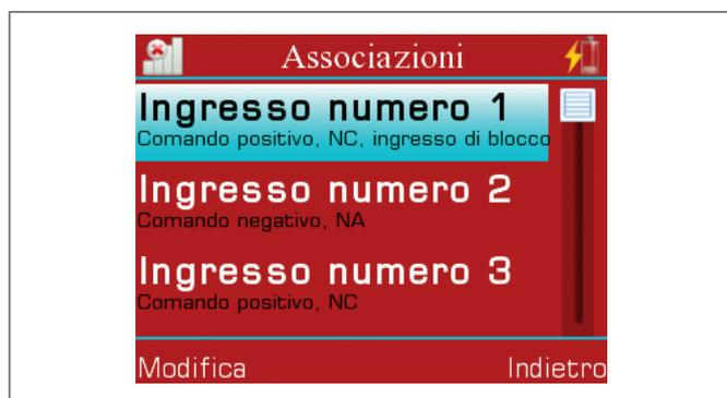
Selezionando un elemento della lista e premendo “Modifica” si accede al menu “Lista Azioni” associate a quel trigger. Da qui è possibile:
