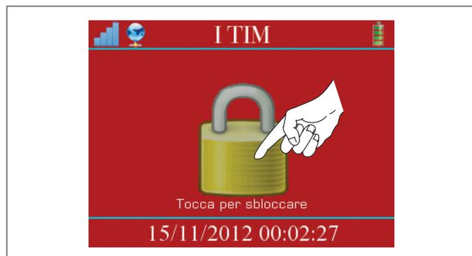
Per sbloccare il combinatore premere sul lucchetto al centro dello schermo e inserire la password amministratore (impostata di default a "12345") attraverso il tastierino numerico touch. Infine concludere l'operazione premendo il tasto di conferma in basso a destra.
