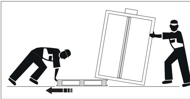
Después de retirar el pallet, baje el armario lentamente, sin sacudidas, para evitar daños.
