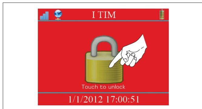
Para desbloquear el marcador, pulse en el candado del centro de la pantalla e introduzca la contraseña de administrador (por defecto, «12345») mediante el teclado numérico táctil. Finalice la operación pulsando el botón de confirmación abajo a la derecha.
