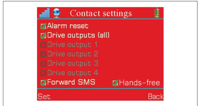
Los ajustes de contacto sirven para otorgar privilegios especiales de control remoto a determinados contactos o para reenviar al número correspondiente los mensajes que recibe el **GSM-00**:
