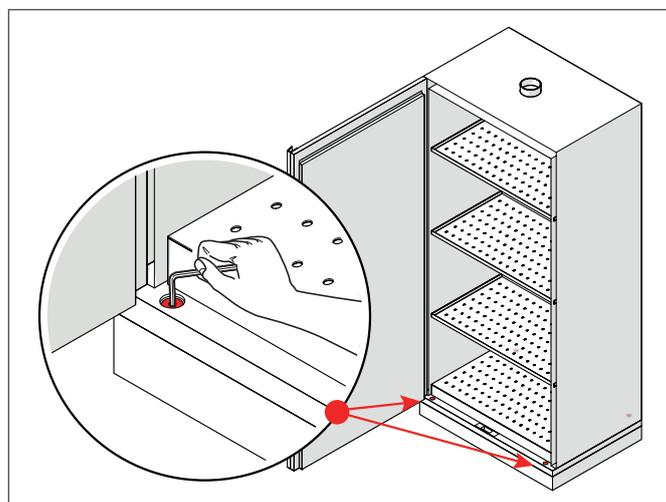
Durante la apertura y el cierre, los elementos de la puerta no deben rozar las juntas ignífugas situadas en la zona de los topes. Las puertas con sistema de cierre automático se deben cerrar automáticamente desde cualquier posición, y la cerradura se tiene que poder bloquear.
