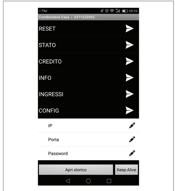
El botón «Keep-Alive», situado en la parte inferior derecha de la página, permite configurar un sistema de monitorización basado en los mensajes de «ESTADO». El menú desplegable permite seleccionar el modo de funcionamiento.
