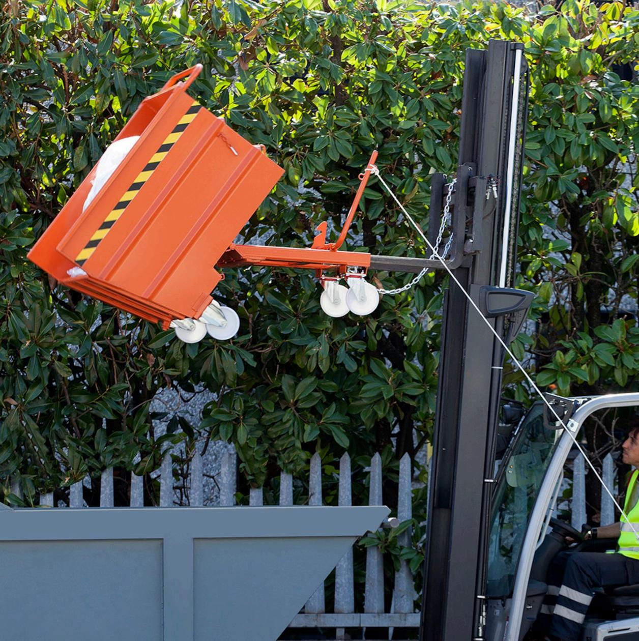
Contenedores tipo volquete multiusos de acero al carbono pintado S235JR para la descarga y manipulación seguras de materiales industriales. Uso indicado para todas las industrias, el operador activa el mecanismo de descarga desde el montacargas sin necesidad de salir del vehículo.
